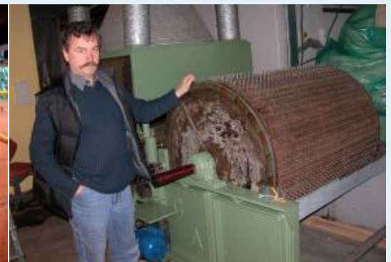
Die Kardmaschine wird hier gerade überholt und instand gestellt.
